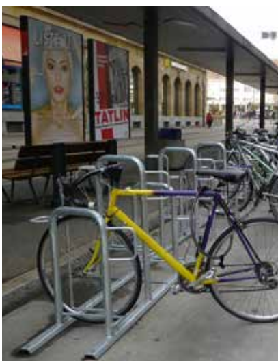
Besonders geeignet an öV-Haltestellen: Vorderradhalter mit Anschlussvorrichtung, Schieberinne mit hoch-/tief versetzten Vorderrädern und Doppelstockparker
