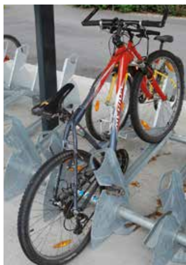
Besonders geeignet an öV-Haltestellen: Vorderradhalter mit Anschlussvorrichtung, Schieberinne mit hoch-/tief versetzten Vorderrädern und Doppelstockparker
