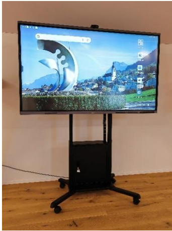
Hisens Touch Screen Display 86" Höhenverstellbarer Rollwagen (UK Display min. 45 cm / max. 143 cm) Integrierter Videokonferenzanlage 2 Dongle für drahtlose Verbindung Laptop mit Display
