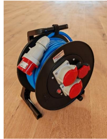
Kabelrolle DEM DB32442 1xT75 1xT25 5x1.5mm² 25m Stecker T75
