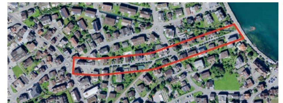
Bei der Fischmattstrasse ist eine Strassen- und Trottoirsanierung erforderlich, wobei ein sogenannter «Vollausbau» vorgesehen ist. Dies bedeutet den Ersatz der Fundationschicht, neue Randabschlüsse und den Ersatz der bituminösen Beläge. Das Trottoir wird neu über die gesamte Länge sichtbar erhöht und mit einem
