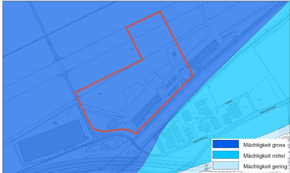
Abbildung 36: Grundwassermächtigkeit (Quelle: WebGIS Kt. NW)
