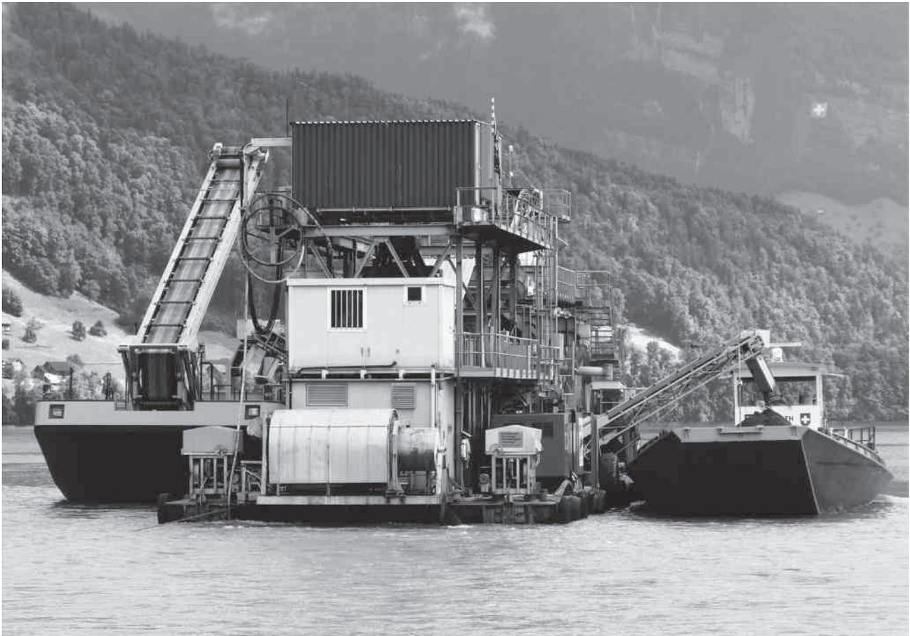
Der Kies wird direkt auf der Schwimmbaggeranlage gewaschen, ausgesiebt und nach Fraktionen auf den Nauen verladen.
